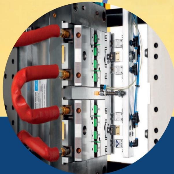
8-fach Teileentnahme mit anschließender Laser 3D-Vermessung
