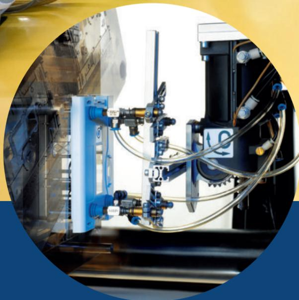
2-Komponenten-Fertigung mit Drehteller-Technik
